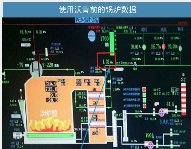
在运行压力不变的情况下，如果未使用沃肯，给水母管的压力会随着使用时间增加，水垢增加，因此压力也增加。
