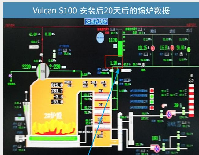
使用同样的运行压力，在运行20天后，给水母管已经降压运行0.12MPa。
