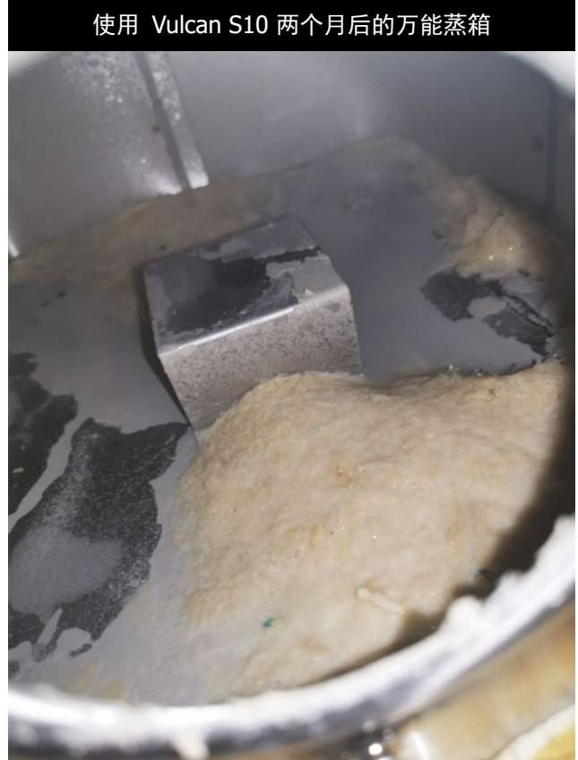
水垢呈片状无法从蒸箱排污孔排出，为测试确定沃肯系统的效果，安装Vulcan S10前没有进行排污清理。
