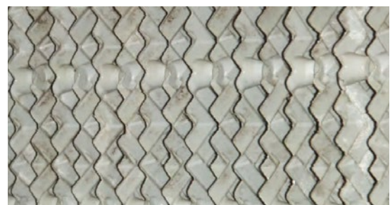
沃肯(Vulcan)安装5个月后: 水垢已经变少
