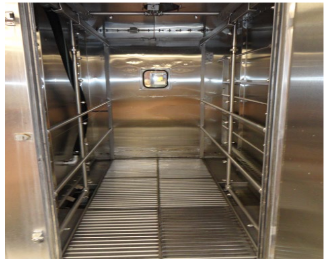
Lavadora de rejilla de acero inoxidable completamente exenta de cal
