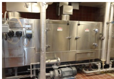
Lavadora de rejilla de acero inoxidable completamente exenta de cal
