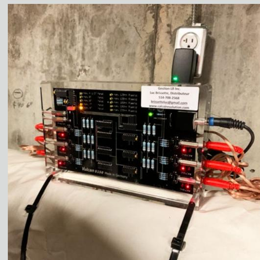
Se instaló Vulcan S10 en la recirculación del agua caliente, situada en la planta número 27. Antes de instalar el equipo Vulcan se procedió a cubrir las bandas impulsoras para evitar la condensación.
